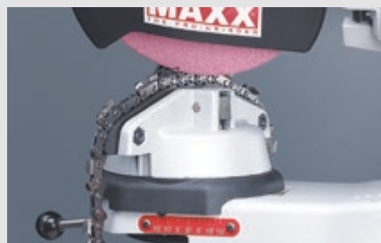
Úprava obmedzovacieho zubu
