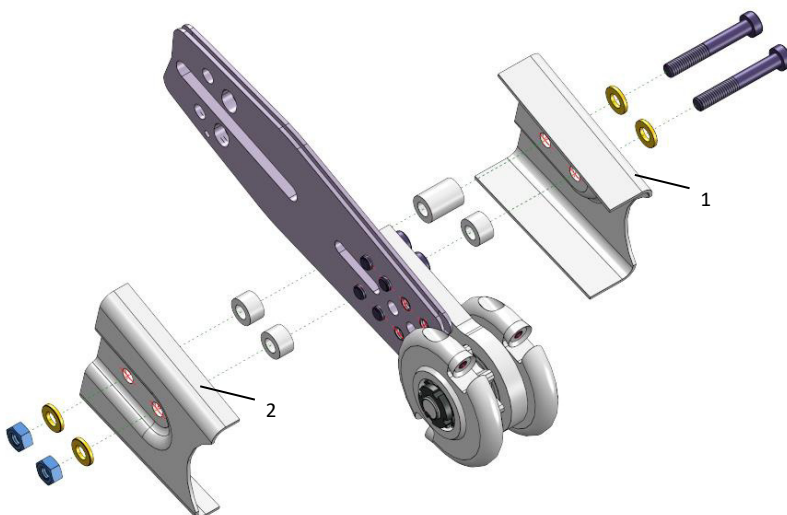
Obr. 2. Montáž ochranných plechů
