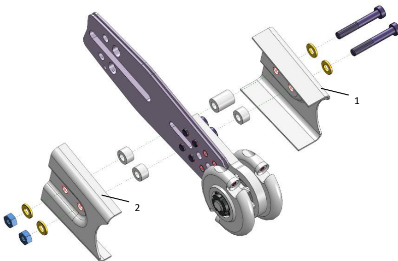
Fig. 2. Montaje de las placas protectoras
