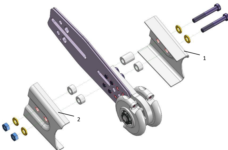
Joon. 2. Kaitseplekkide montaaž
