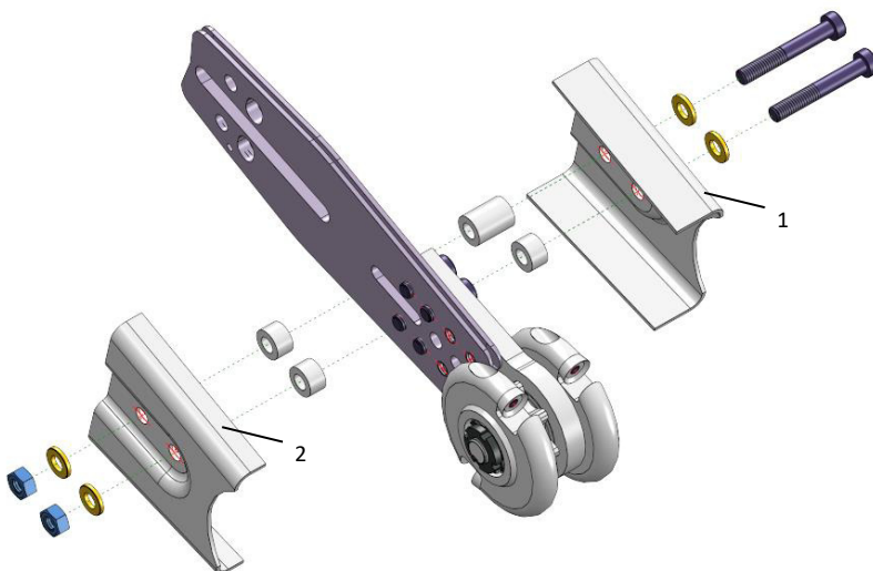
Fig. 2. Montering av verneplater
