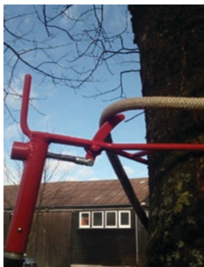
Abb. 2: Verhalten des klappbaren Hakens bei Seilanzug
