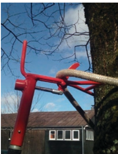
Abb. 2: Verhalten des klappbaren Hakens bei Seilanzug
