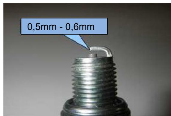
Abb. 15: Elektrodenabstand
