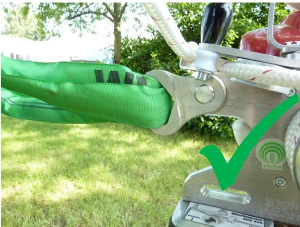
Abb. 7: Richtige Befestigung der EDER Powerwinch
