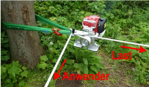
Abb. 4: EDER Powerwinch 500 in Arbeitsposition
