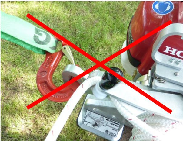
Abb. 6: Falsche Befestigung der EDER Powerwinch
