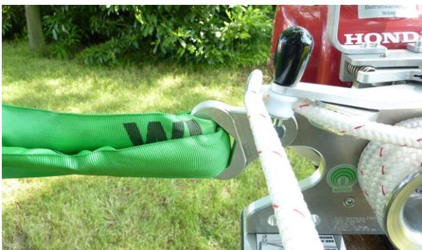
Abb. 5: Seilführung durch die Seilklemme
