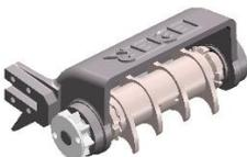
**Aufbau:** Die Borkenkäferfräse EBF-C wird an ein zur Motorsäge passendes Schwert montiert und wie eine normale Kettensäge mit einer Kette angetrieben. An der Motorsäge sind keine Veränderungen erforderlich.
