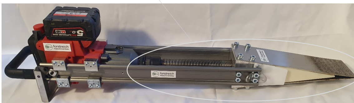
Hintere Endlage des fernbedienbaren Fällkeils – detektiert durch den Magneten auf der rechten Schiene
