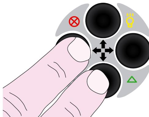
Verwenden Sie **Escape**, um ein Menü zu verlassen oder eine laufende Kermit-Kommunikation zu unterbrechen. Drücken Sie beide Tasten gleichzeitig, wie auf dem Bild gezeigt.
