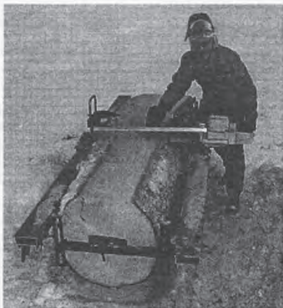
Big Mill PRO: LSG mit Doppel Führungsholmen, EXT Arm und Befestigungsplatten EXT. Die Gleitprofile (Nr.4 Seite 27) dürfen den Baumstamm nicht berühren.
