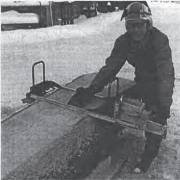
LSG ohne Führungsholm. Die glatte Oberfläche des Baumstamms führt den nächsten Schnitt.
