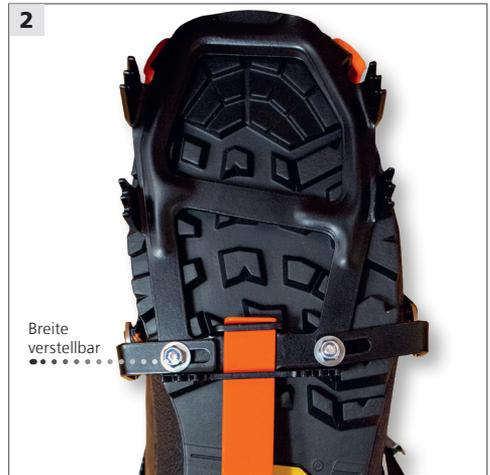
Die Breite der Steigeisen ist mit einem Gabel-Ringschlüssel (8 mm) von 95 mm bis 120 mm verstellbar.
