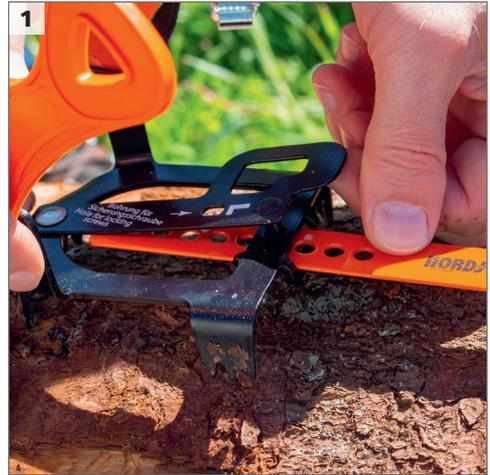
Um die richtige Länge für Ihren Schuh einzustellen, heben Sie die Verstellfeder an und wählen die entsprechende Ausnehmung im Verbindungssteg. Der Standardsteg passt für die Schuhgrößen EU 39–49.
