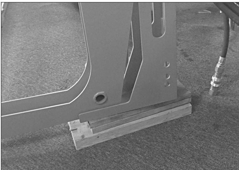
Monteringsfästet (artikel 17) är avsett att fästa vagnen (artikel 16) och lastarmen (artikel 15) vid sågverksunderlaget. Vagnen är inte utformad för att hålla upp stockens vikt, så det är nödvändigt att stödja vagnen ordentligt mot marken. Om marken är ojämn och/eller mjuk ska plankor eller liknande användas genom att ge ordentligt stöd.
