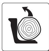
Ziehen Sie den Hebel des Laders nach unten, um den Stamm auf den Sägebettrahmen zu heben. Heben Sie ihn soweit an, bis der Stamm auf den Sägebettrahmen rollt.
