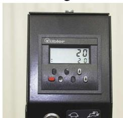
Die rote Taste für Neustart (reset) am Zählwerk drücken.
