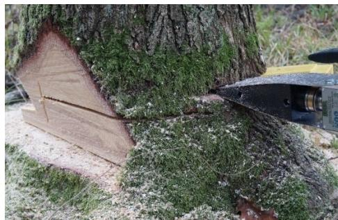
Es obligatorio realizar el corte de tala descentrado, ya que así se evita el contacto peligroso entre la Titan 80 Pro y la cadena de la motosierra.
