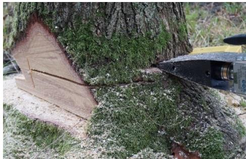
Je povinné provést odsazený hlavní řez, protože se tím zabrání nebezpečnému kontaktu mezi přístrojem Titan 80 Pro a řetězem motorové pily.
